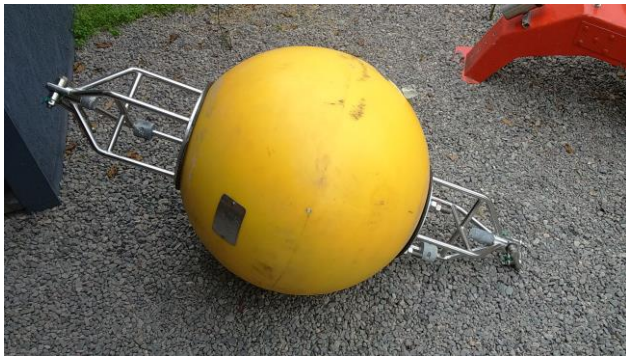
Sistema de fondeo ADCP.
