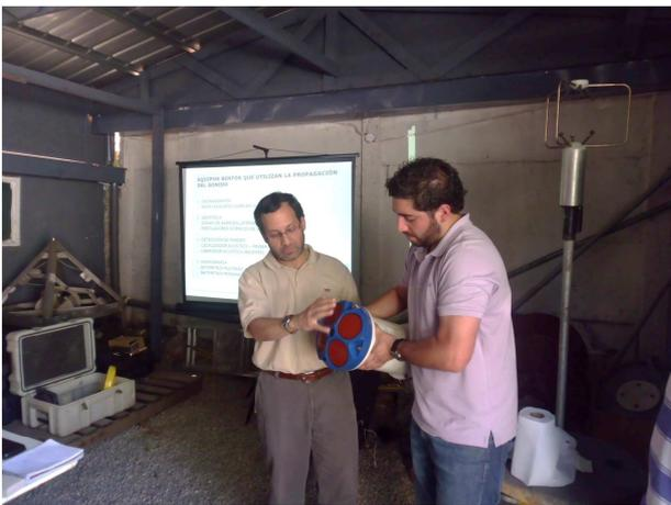
Muestra de equipo oceanográfico, ADCP.
