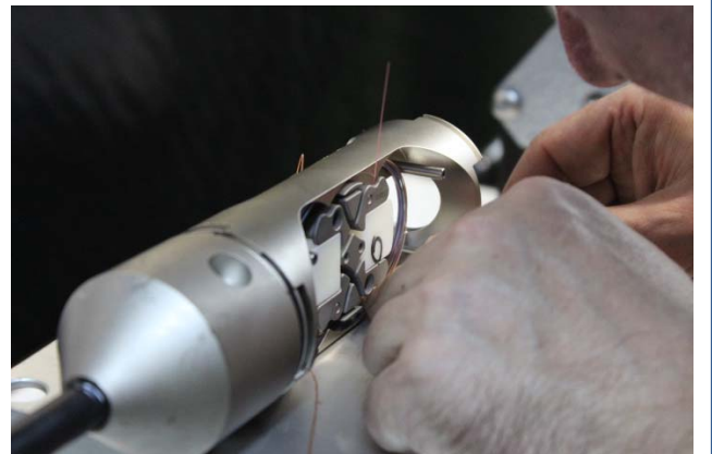
Empalme submarino, pieza metálica usada para la unión de secciones del cable.
