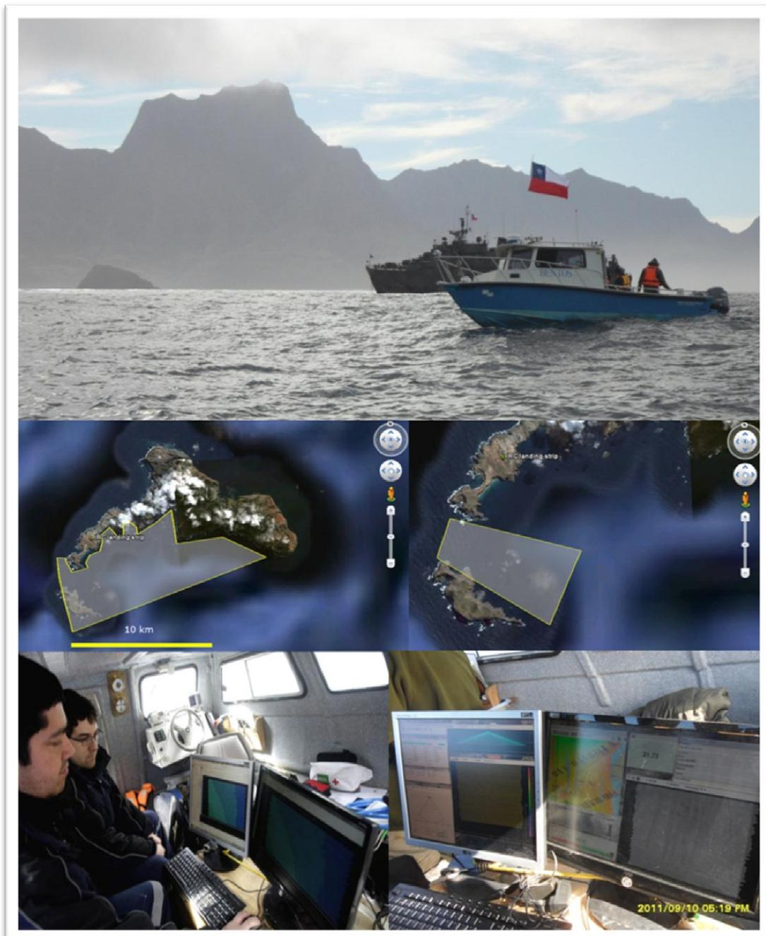
Considerando la necesidad de efectuar una búsqueda eficiente, precisa y rápida, se decidió realizarla usando un sistema de ecosonda multihaz de última generación (R2Sonic 2024); tecnología con el cual se detectaron anomalías sobre el fondo posiblemente correspondiente a los restos de la aeronave siniestrada; información que fue posteriormente verificada y confirmada por los buzos y ROV.
